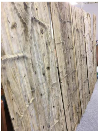
NC加工機による加工後の型枠材
